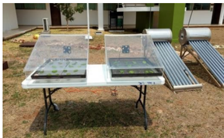
Figura 1. Secador solar directo tipo gabinete
